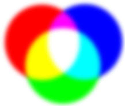
(a) Das weiße Licht wird bei der additiven Farbmischung durch die Mischung von rotem, grünem und blauem Licht (RGB) mit unterschiedlichen Wellenlängen erzeugt. Der Vorteil bei dieser Methode: Durch gezielte Ansteuerung kann die Lichtfarbe verändert werden. So kann neben weißem Licht auf Wunsch auch farbiges Licht erzeugt werden. Dieses Verfahren wird zum Beispiel im Bereich von LED-Fernsehern angewendet, bei denen LED zur Bilddarstellung und zur Hintergrundbeleuchtung eingesetzt werden.
