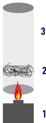
Abbildung 2 : Skizze des Aufbaus des Rijke-Rohrs mit Bunsenbrenner(1) zum Erhitzen des Metallgitters (2) im aufgehängten Glasrohr (3)
