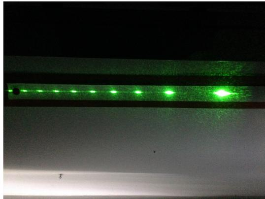
(b) Bild des Beugungsgitters, an der Wand.
